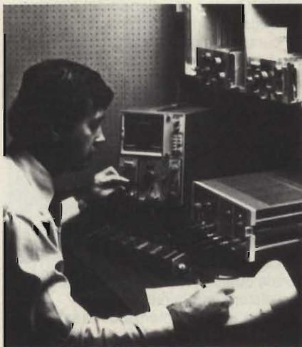
Analizzatore di spettro per radiofrequenza a memoria digitale.
