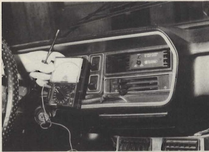
Controllo finale dei collegamenti di un amplificatore "KC/5130-00". L'alimentazione deve essere ricavata "dopo" alla chiavetta d'accensione, per evitare di spegnere il solo autoradio dimenticando acceso l'apparecchio.
